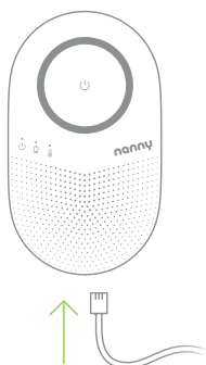
Obr. 9 Připojení propojovacího kabelu k vyhodnocovací jednotce
